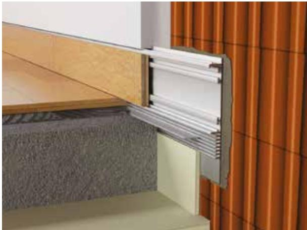
BFZ ist ein Konstruktionsprofil, mit dem Sie eine wandbündige Fußleiste aus dem gleichen Material des Bodens erstellen können. Im unteren Teil befinden sich spezielle Rillen, die das ineinandergreifen eines linearen profils ermöglichen, um die Höhe des Estrichs zu bestimmen und eine perfekte Positionierung der Höhen von Türen und Fenstern zu gewährleisten.
